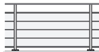
Modèle ÉOLIA Lisses horizontales à vides égaux et vitrage 44.2
